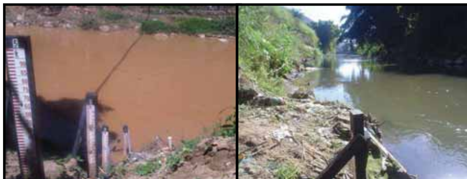
Figura 5.11 – Seção de régua da estação fluviométrica de Pedro do Rio/RJ.
